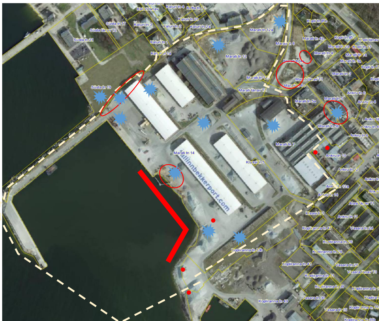
Joonis 4. Skemaatiline ülevaade Maa-ameti ajalooliste fotode abil tuvastatud võimalikest reostusallikatest (sinisega) ning varasemate uuringutega tuvastatud reostusest (punasega). Planeeringuala on märgitud heleda kriipsjoonega. Aluskaart: Maa-amet.
